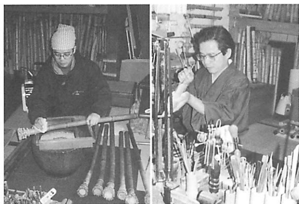
写真左：掘った竹の油抜き作業。竹はこの後5年陰干しに。写真右：深夜、工房にこもり細かい仕込みをする。
